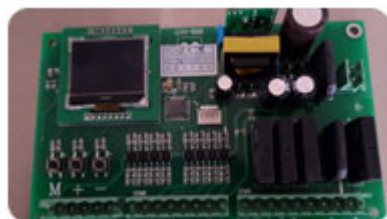
显示屏电路板
